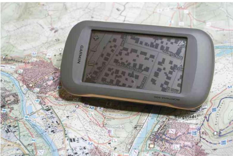
Die tragbaren Navigationsgeräte (hier ein Garmin Montana 600) sind inzwischen so gut, dass sie selbst in Innenräumen am Fenster noch so viele Satelliten-Signale empfangen und damit die Position
